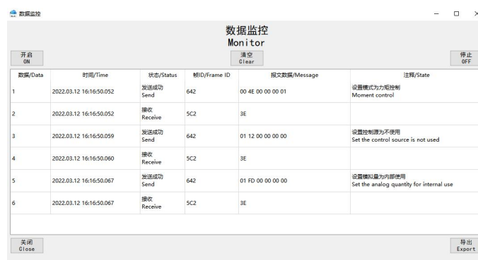
图 4-25 “设置控制模式”按钮报文数据监控
