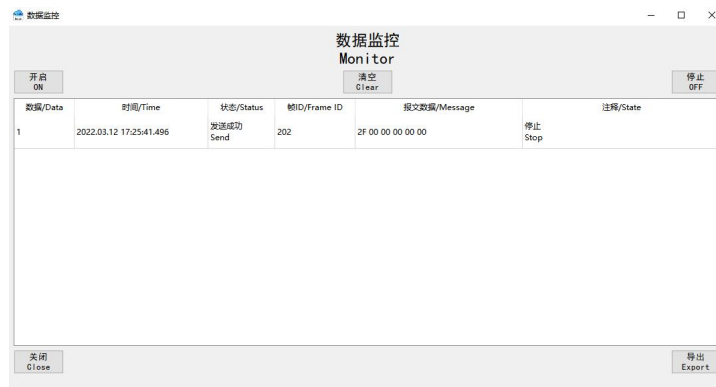
图 5-30 周期同步速度模式“停止”按钮报文数据
